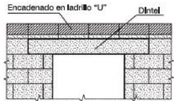
Fig. 8 - Ubicación de dinteles sobre las aberturas
