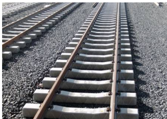
Durmiente de hormigón monobloque.
