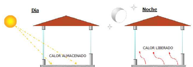
Figura 8: Esquema del funcionamiento de la Masa Térmica en INVIERNO
