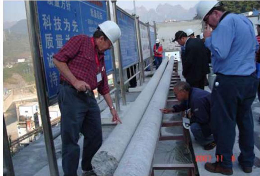
Testigos de hasta 5 m de largo extraídos Jiangya Dam y Testigos de 15 m extraídos en Longtan Dam donde se utilizó un HCR de alto CMC y aditivo retardador de fraguado
