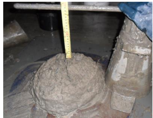
Figura 4. Hormigón de consistencia fluida.
