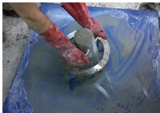
Figura 4. Anillo J de acuerdo con la norma ASTM C 1621, para evaluación de la capacidad de pasaje del HAC.
