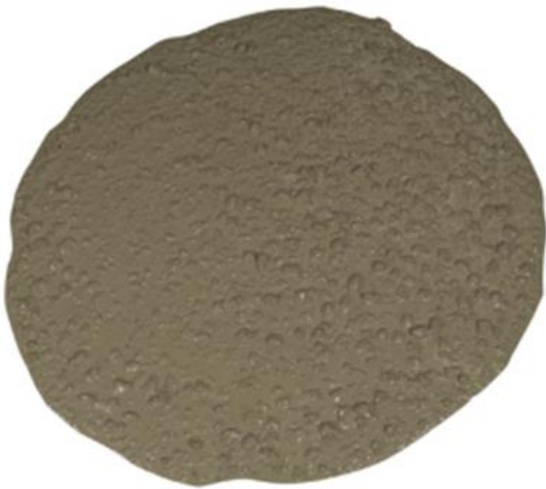
Figura 3a. IEV=0 La masa de hormigón es homogénea y no evidencia exudación.
