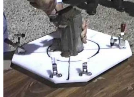
Figura 4. Ensayo de fluidez según norma ASTM D 6103.
