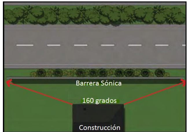
Ilustración 20: Consideraciones para determinar la longitud de la barrera (9)
