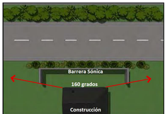
Ilustración 21: Alternativa en caso de no disponer de la longitud requerida para la barrera (10)
