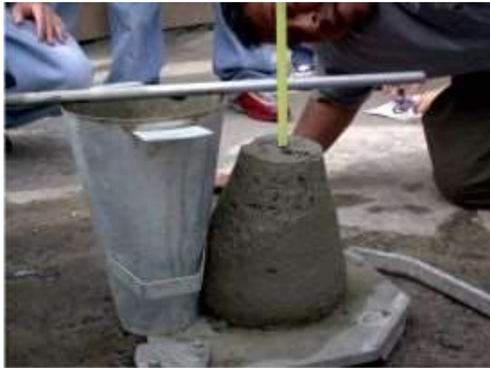
Fig. 4.11 Ensayo de asentamientos del cono de Abrams.
