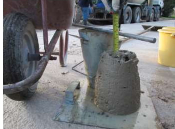
Fig. 4.11 Ensayo de asentamientos del cono de Abrams.
