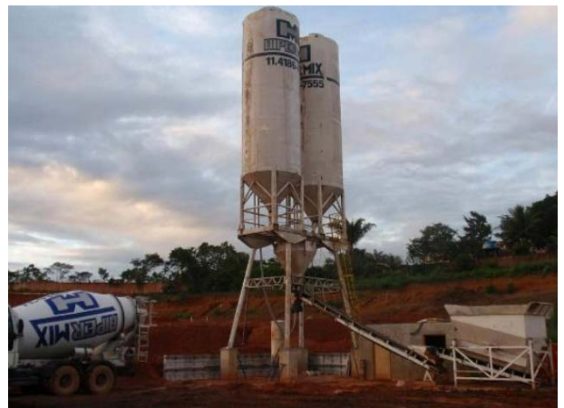
Figuras 11.8 a 11.9. Instalación de una planta elaboradora dentro de la obra en un proyecto habitacional con este sistema.
